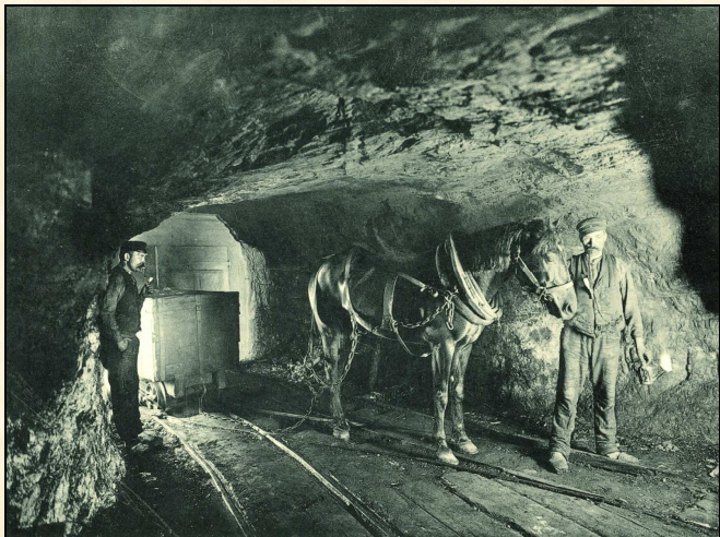
Tak wyglądał transport konny materiałów i urobku na dole w większości kopalń, m.in. w kopalniach „Leopold” i „Orzesze”
